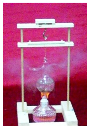
圖1 加熱透明希侖蒸汽機中的工作流體，使工作流體沸騰，並且(產生蒸氣)而劇烈膨脹，驅動希侖蒸汽機轉動，使得學習者可以完全了解：希侖蒸汽機中工作流體到底如何做功。
