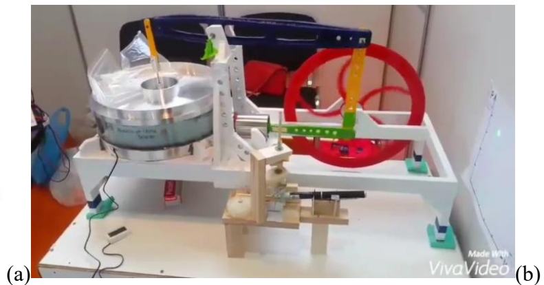
圖 13 可以目視、直觀體會的工作流體 PV 圖演示儀。
