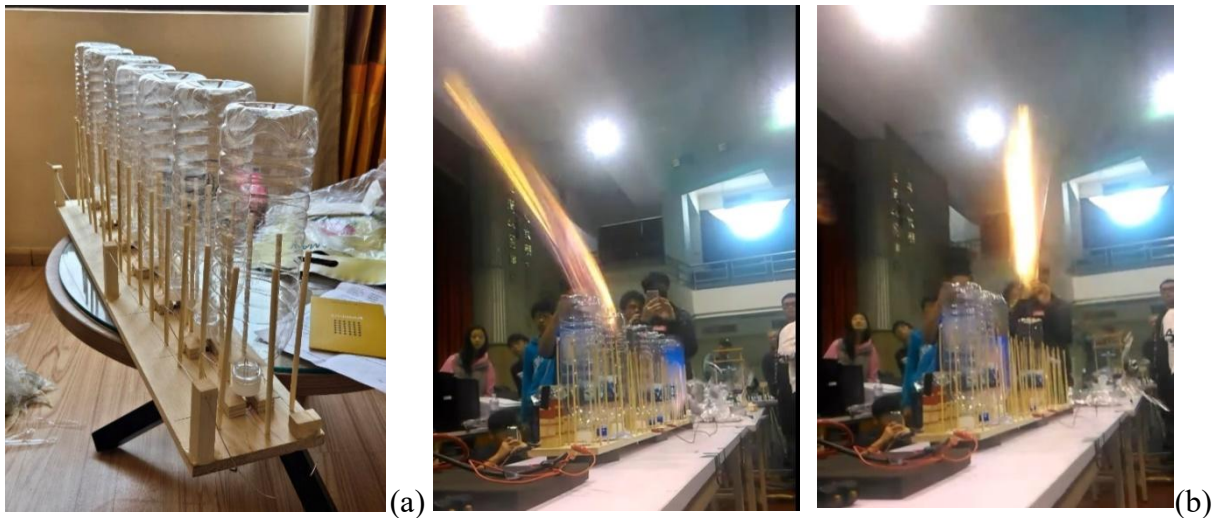
圖 12 並列在發射架上的多個醇類火箭(a)。多個醇類火箭發射的情形(b)。
