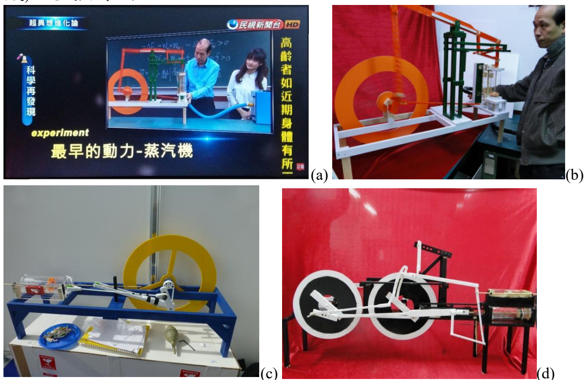
圖 2 完全透明的古老蒸汽機模型(a 與 b)。晚期較為先進的往復式蒸汽機(c)，這種蒸汽機最後裝設在蒸汽火車頭上，引領鐵路交通運輸近一百年(d)。
